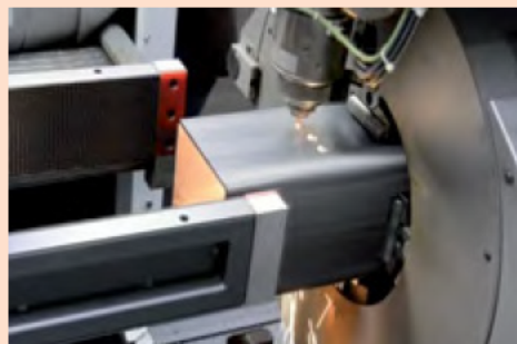
Tubo inox quadro in fase di taglio.
